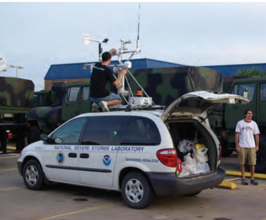
◆ Existen diferentes métodos meteorológicos para medir la intensidad y la velocidad de los huracanes, uno de ellos es este laboratorio instalado en una unidad móvil.
